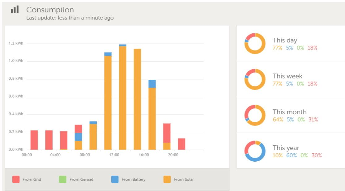
**Hybridní fungování EasySolar** je určeno tam, kde je trvale dostupná distribuční síť připojená na jeho AC vstup. V tomto režimu jednotka upřednostňuje energii z fotovoltaického pole a/nebo baterie před energií ze sítě.
